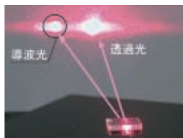
図2. LiF 結晶内部に作成した光導波路の導波実験写真
